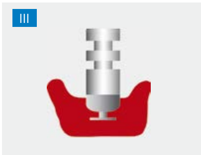
Die Abformkappe bleibt im Abdruck stecken. Das Laboranalog wird aufgesteckt
