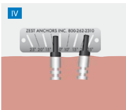
Mit den Richtungsindikatoren und Angulierungsmaßstab den Winkel ermitteln
