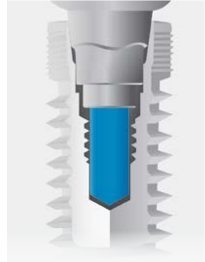
Abb. 71: Detailansicht des Abutmentauswerfers im Implantat
